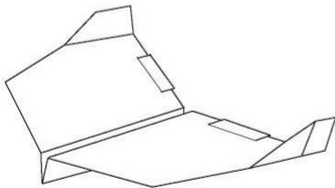
Piega le ali verso il basso lungo le linee 6 e le alette verso l'alto lungo le linee 7. Taglia fessure lungo il bordo posteriore delle ali per regolare l'elevatore. Aggiungi una dihedral alle ali inclinandole leggermente verso l'alto. Le ali avranno una leggera forma a "V". Ora sei pronto per volare!
