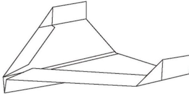
Questo aereo produce molta portanza a bassa velocità, con una bassa pendenza di planata. È eccellente per il volo al chiuso e planerà lentamente attraversando la stanza.
